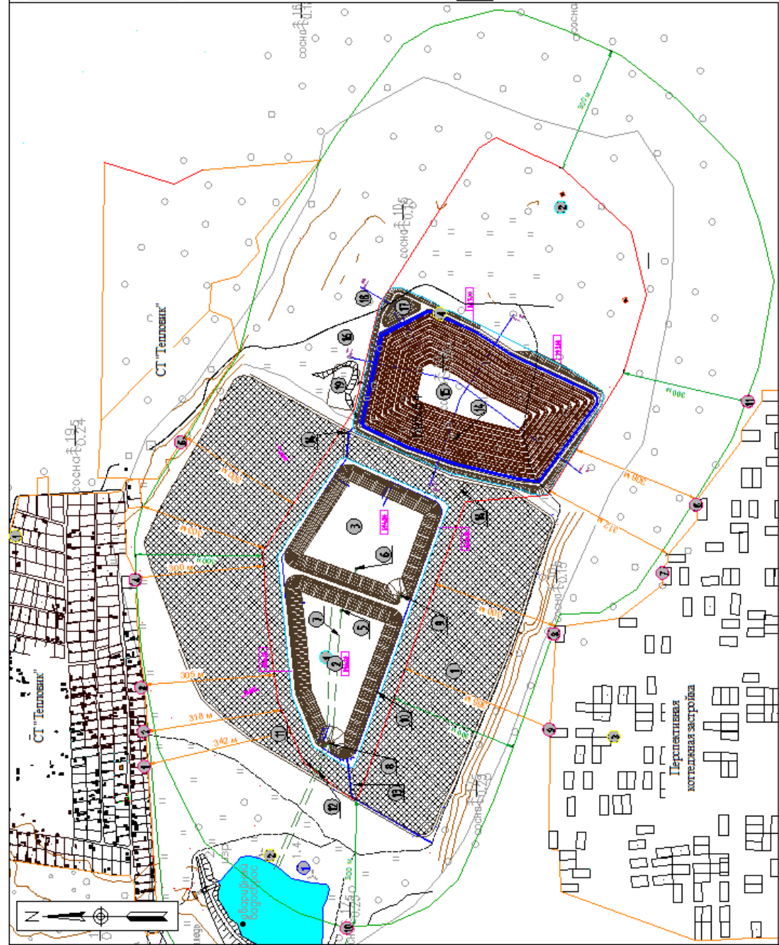
Рисунок 2. Ситуационная схема расположения промплощадки золотоговара на ст. Тальцы Улан-Удэнской ТЭЦ-1, границы жилой застройки, точек замера шума, отбора проб в воздухе, воды и почвы Масштаб 1:5000
